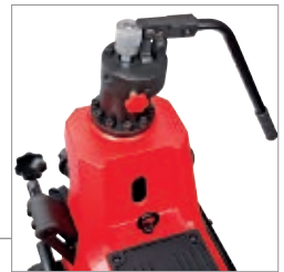
Hidravlični cilindri za fino nastavitve globine utora
