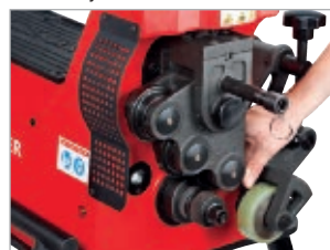
3-krat nastavitve velikosti tlaka valjev brez orodja
